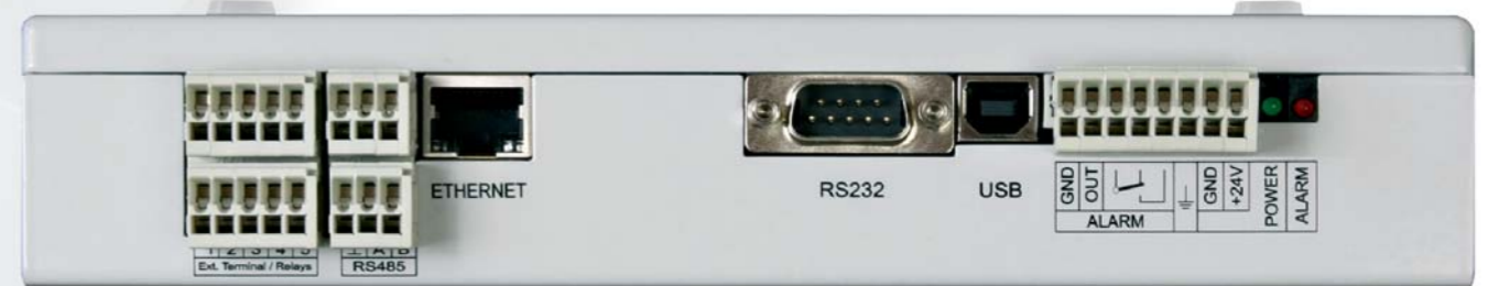
RS232, RS485 i USB izlazi. Ethernet izlazni interfejs je opcionalan.
